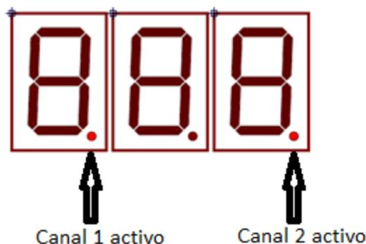
Los puntos de los display 1 y 3 indican el estado del canal 1(Relé 1) y canal 2(Relé 2) respectivamente, como se ilustra en la figura de la izquierda.
